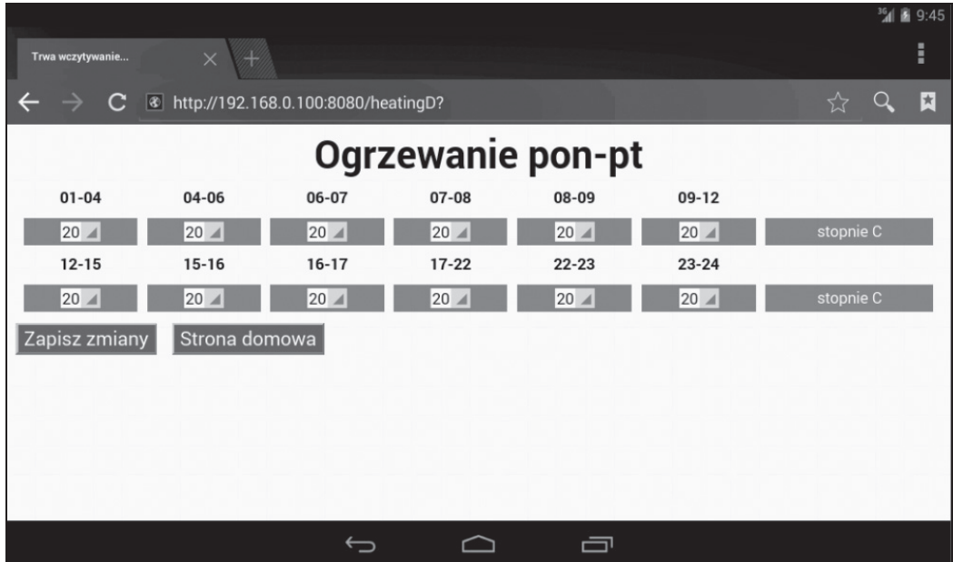
RYСУNEK 9.2. Sterownik automatyki domowej — regulacja temperatury
